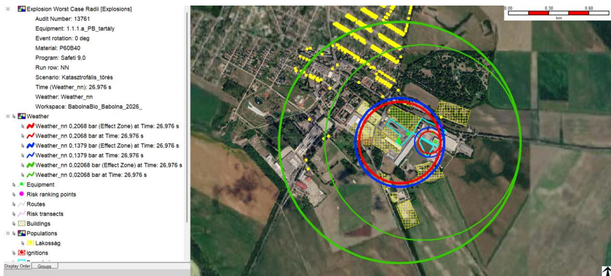
21. ábra: A nyári nappal 1.1.1.a_PB_tartály katasztrofális törése baleseti esemény sor bemutatása. Túlnyomás görbék robbanás esetén. Piros: 0,2 bar, kék: 0,13 bar, zöld: 0,02 bar túlnyomás értékek burkoló görbéi, nyugati szél esetén (vékony vonal) és hatásövezete (vastag vonal).
