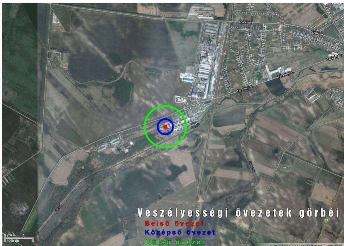
21. ábra: A veszélyességi övezetek a környezet térképén
